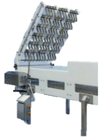
(b) Stansas #1 i åpen modus for enkel rengjøring
