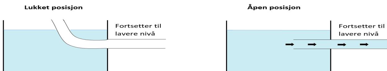
Figur 4.11: Fleksibelt rør med høyderegulering som fungerer som skånsom start og stopp av fiskestrøm.
