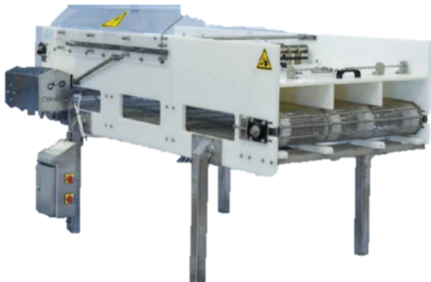
(a) Stansas #1 med tre bedøvelseskanaler i lukket bedøvelsesmodus.
