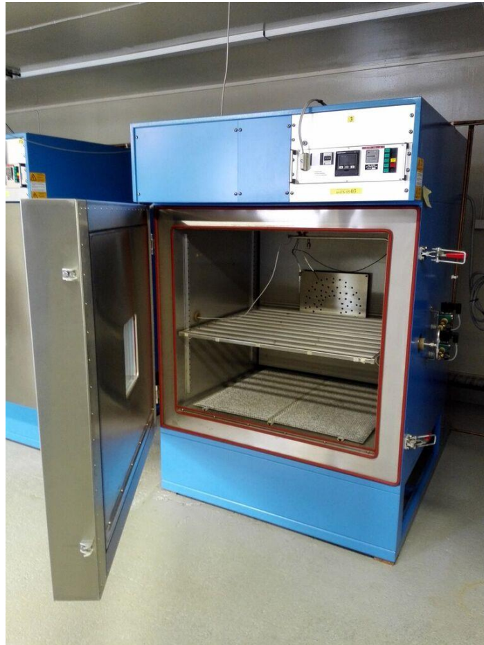
Figur 3-3: Frysekammer ved SKP, brukt til å fryse plastrørene ned til -72 °C
