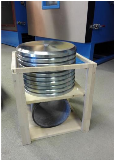
Figur 3-5: Foto av måling av deformasjon med påført last i romtemperatur utenfor frysekammeret
