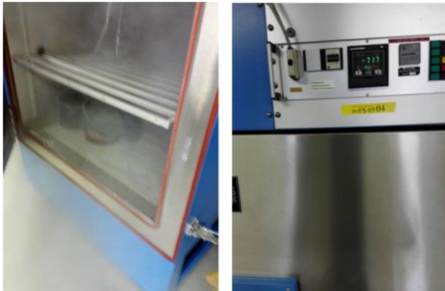
Figur 3-6: Venstre: frostrøyk når døren til frysekammeret åpnes opp ved -72\text{ }^{\circ}\text{C} . Høyre: temperaturindikator på frysekammer som viser at temperaturen etter åpning og lukking av døren er -71,7\text{ }^{\circ}\text{C} .
