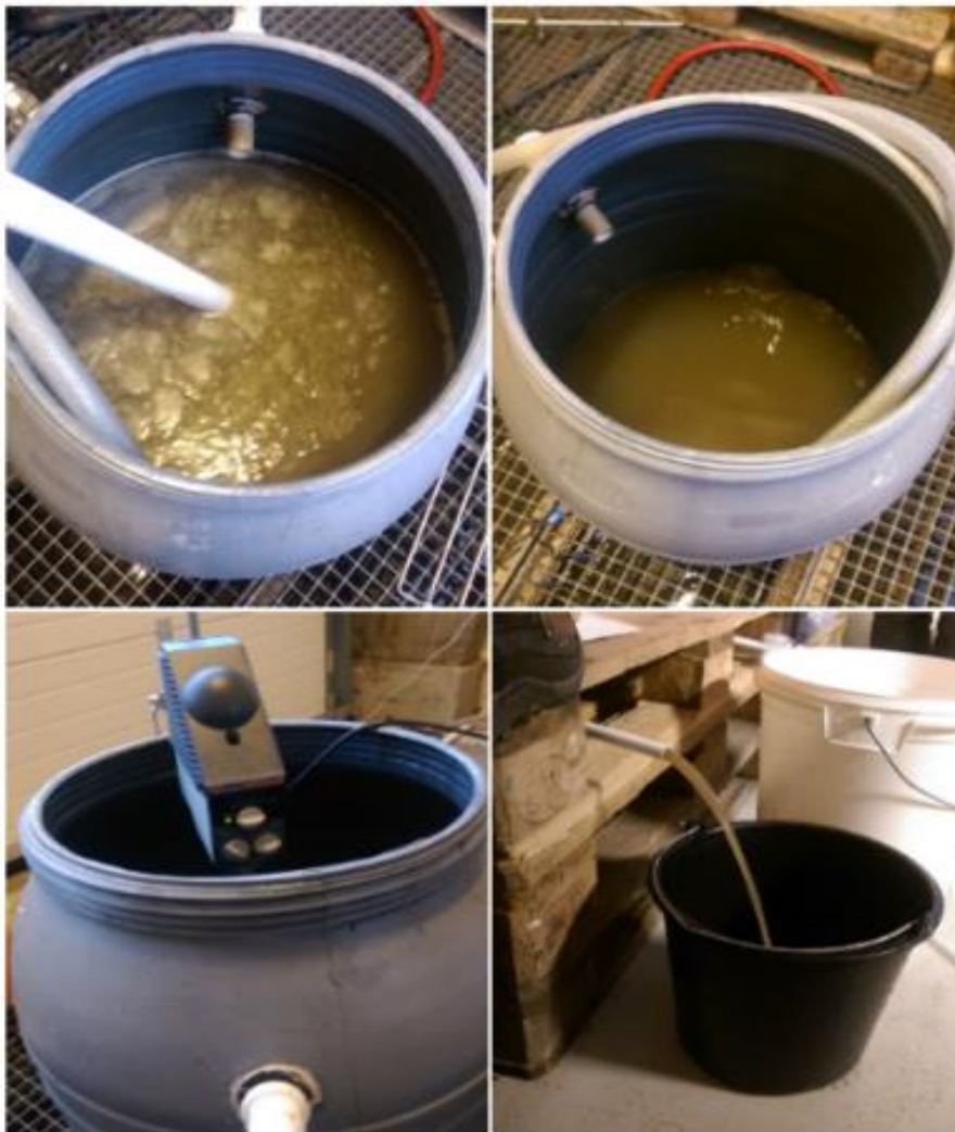
Figur 3.1: De ulike stegene i slamproduksjonen. Øverst til høyre rask miksing. Nederst til høyre langsom miksing. Øverst til venstre sedimentering. Nederst til venstre ferdig slam.
