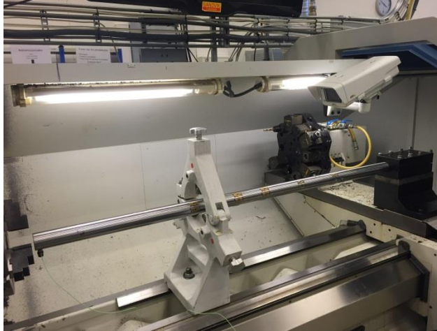
Figur 80: Verktøy fast innspent i den ene enden. NB! Verktøy er ikke innspent i brille.
