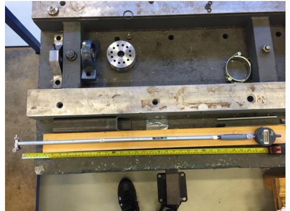
Figur 75: Hullindikator med 65 cm effektiv målelengde og digitalt måleaur.
