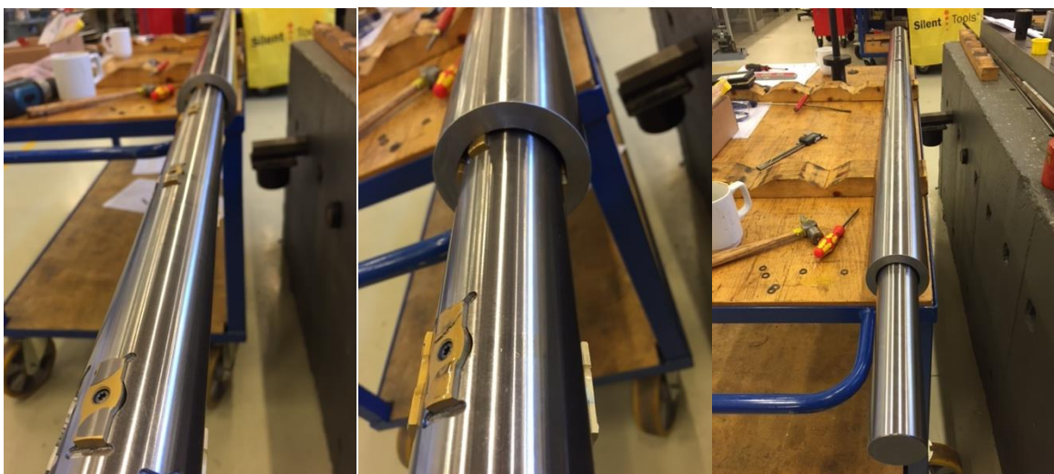
Figur 77: Verktøy i forskjellige posisjoner inne i arbeidsstykke. På bildet til høyre er verktøyet i startposisjon og lengde lik fire ganger egen diameter til innspenning er utstikkende fra arbeidsstykket.
