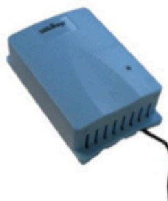
Figur 2 Inneklimalogger for logging av temperatur, relativ fuktighet samt CO 2 i inneluft.
