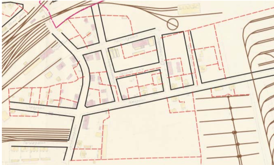
Figur 45: Reguleringsstruktur (sort), eksisterende eiendomsstruktur (rød) og jernbane-tekniske innredninger som spor og svingskive. Den lillastiplede linjen markerer grense for murtvang, hvilket følger Kongsvingerbanens grensegjerde i østlig retning frem til «Kaaregate», ovenfor Nesgata.
