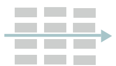
FIGUR 54: vind gjennom gater i kvartalstruktur, vinden ledes og forsterkes fordi det ikke er noen hindringer.
