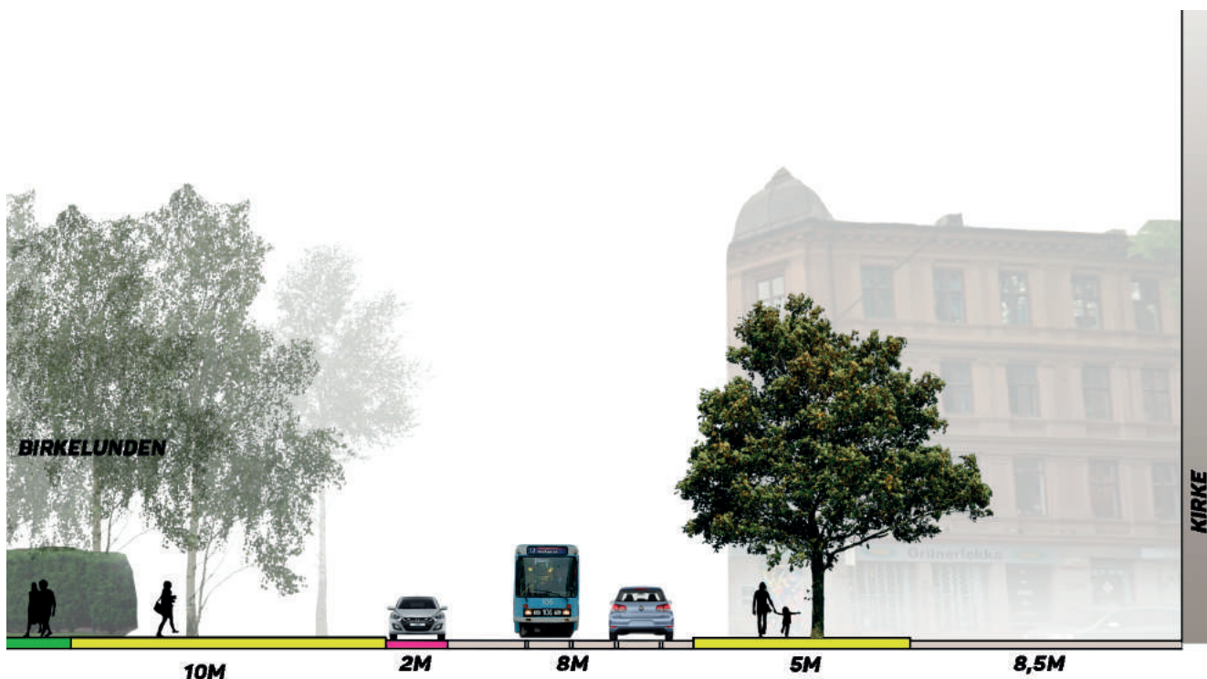
Fig124. Snitt B-B' Målestokk 1:250
