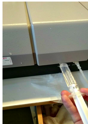
Figur 3-16: Prøve injisert i Zetasizer ved analyse av zetapotensial. Foto: Ingrid Marie Johnsen.
