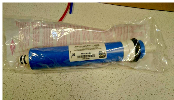
Figur 3-9: Membran med kapasitet 50 gpd før installering. Foto: Ingrid Marie Johnsen
