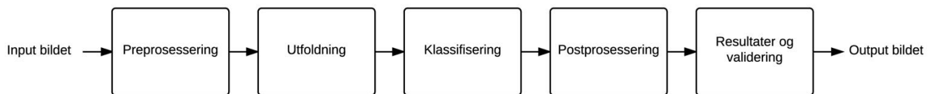
Figur 4-1: Oppbyggingen av svulstinntegningsprogrammet. Input til programmet er MR-bilder av livmorhalskreft. Bildene preprosesseres for å kompensere for intensitetsforskjeller mellom pasientene. Under utfolding brettes bildene ut i en datamatrise som inneholder intensitetsverdier til en bestemt voksel i bildet. Klassifiseringen skjer ved at hver voksel klassifiseres som svulst/ikke-svulst ved bruk av datamatriksen og en klassifiseringsalgoritme. Bildene postprosesseres for å fjerne ubetydelig støy. Resultater og validering blir brukt til å vurdere programmets ytelse ved å sammenligne dataprogrammets bilder (output bildet) med radiologens inntegninger.
