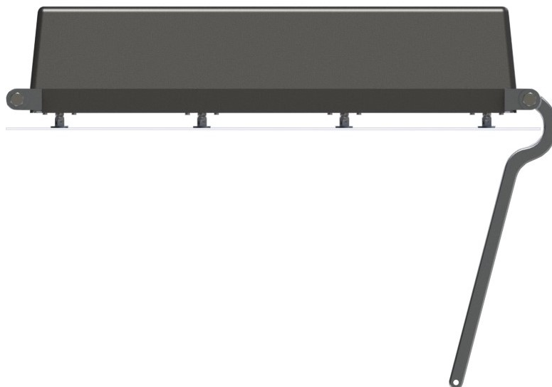
Figur 14.7: Fullskala designforslag, sett fra siden. Festearm er montert andre veien for å gjøre det mulig å benytte denne til f. eks. montering av lysarmatur som på Figur 14.5 på forrige side.
