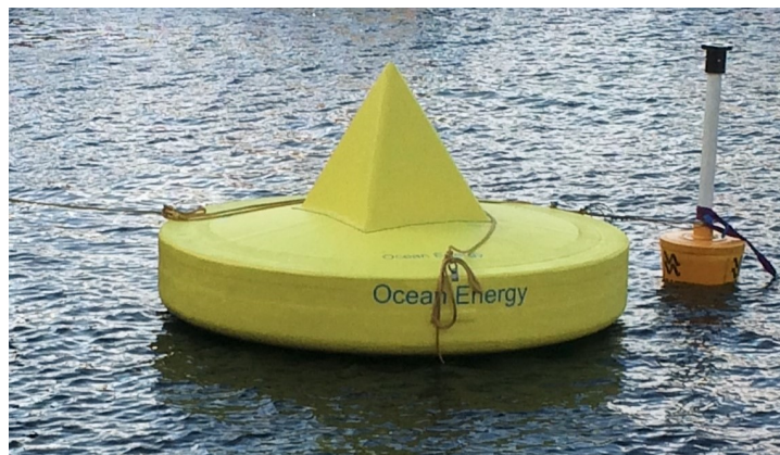
Figur 1.14: Prototypen av OCEs «The Storm Buoy» uten vinsj eller generator, som flyter fritt i havet (Foto: Asbjørn Skotte).
