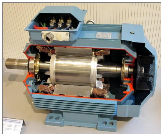
Figur 3-17: En typisk asynkronmotor (Wikimedia Commons 2011)
