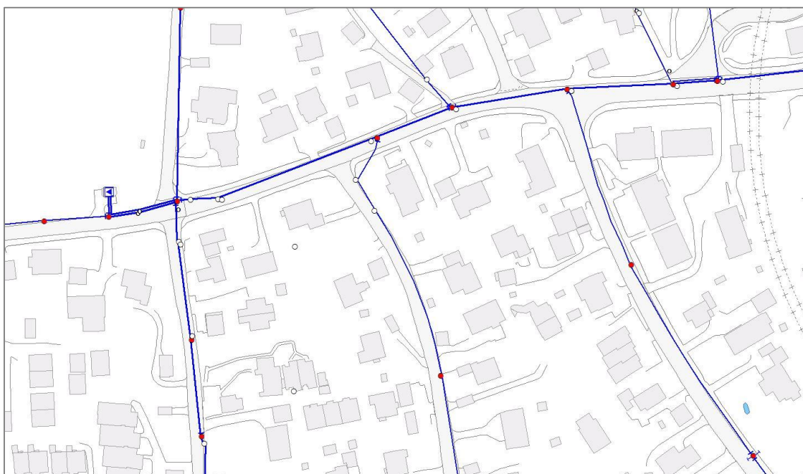
Figur 5-1: Utsnitt av Oslos Distribusjonsnett med pumpestasjon, kummer og brannkummer (Aulie 2015)
