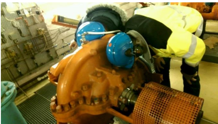
Figur 0-1: Lytting etter kavitasjon ved kavitasjonstest (Myra 2016)
