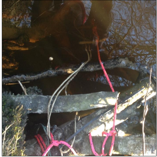
Figur 3.2: Logger i Åkentobekken festet i to tau som videre er bundet rundt flere røtter. Utenfor bildet er tauet surret to runder rundt treet. Knutene er sikret med strips. Bildet er tatt 16.03.16
