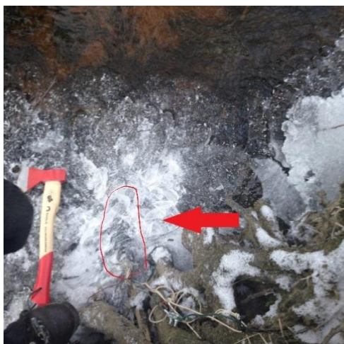
Figur 4.10: Innefryst logger i Hjelmungbekken. Rett utenfor er det ingen is på bekken og vannet renner som vanlig. Rød ring og pil viser loggeren i issvullen. Bilde er tatt 07.01.16
