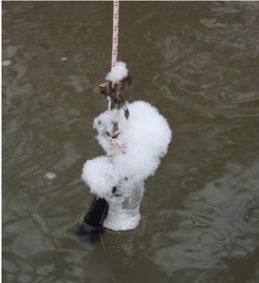
Figur 4.1: Vannstanden har sunket og deler av loggeren er over vann i Årungselsva (Vasumkrysset). I tillegg er det snø og is rundt temperaturmålerdelen av loggeren. Bildet er tatt 09.01.16.
