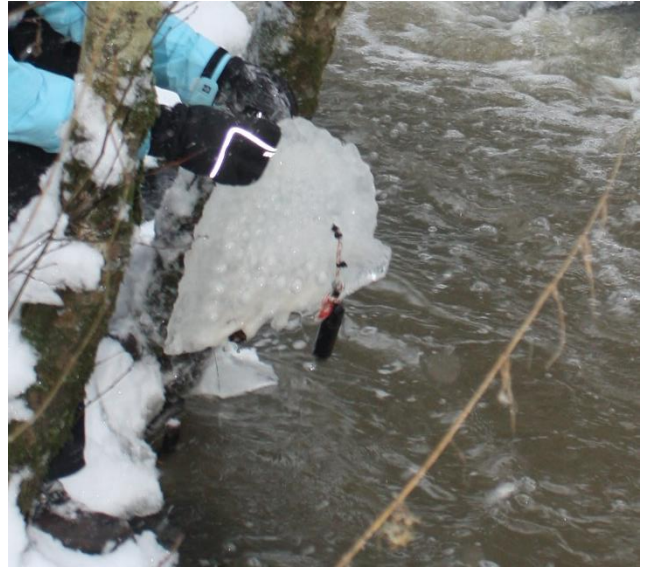
Figur 4.2: Et isflak er dannet rundt tauet som loggeren ved Årungen i Årungselsva henger i. Isflaket berører ikke loggeren direkte men ligger som et lokk over. Bildet er tatt 09.01.16
