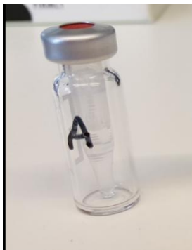
Figur 26: Viser prøve A i en LC-vial beholder med plast insert.
