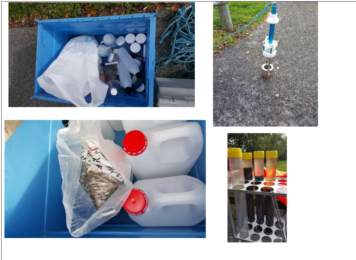
Figur 16: Utstyr til prøvetaking og oppbevaring. Øverst til venstre er det destillert vann, og prøvetakingsflasker. Øverst til høyre er sedimenthenteren (Uwitec sedimentprøvetaker 28). Nederst til venstre er beholdere for vannprøver og hentede jordprøver. Nederst til høyre er sedimentrør med sedimentprøver
