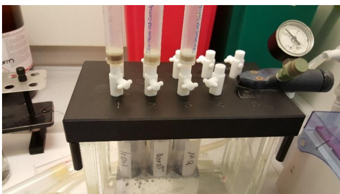
Figur 19: Ekstraksjon av glyfosat og AMPA med Oasis Prime HLB kolonne. Til venstre er kaliumhydroksid (KOH), i midten tetraborat og til høyre vises MQ-vann.
