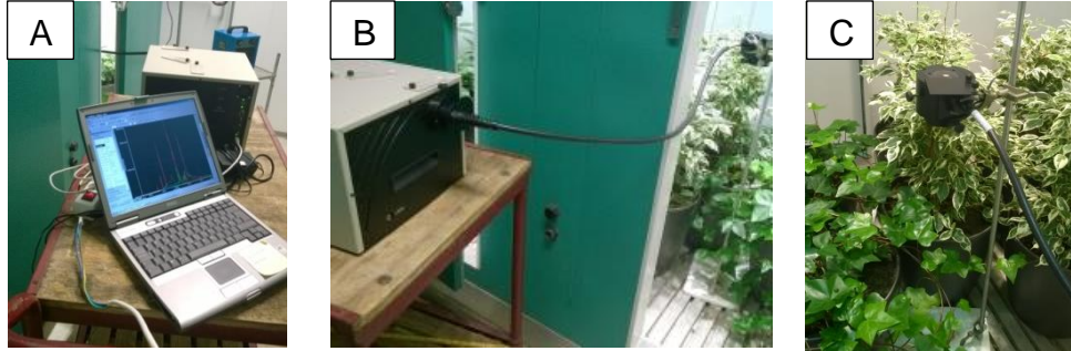
Figur 4. Lysspekteret ble målt under de forskjellige lyskildene i hvert kammer med OL756 Spectroradiometer (A og B). Sensoren som måler lysspekteret ble festet til et stativ for å ta sammenlignbare målinger (C).
