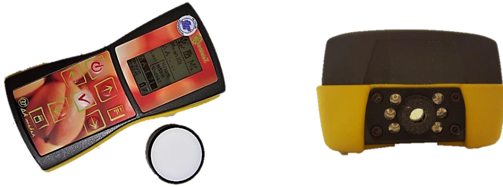
Figur 9: Bildet til venstre viser DA-meteret med referansebrikke. Bildet til høyre viser DA-meteret frå framsida med LED-lys og sensor. Sensoren er plassert i sentrum og dei 6 LED-lysa plassert rundt, 3 som avgjer lys ved 670 nm og 3 som avgjer lys ved 720nm. Foto: Ingvill Hauso.
