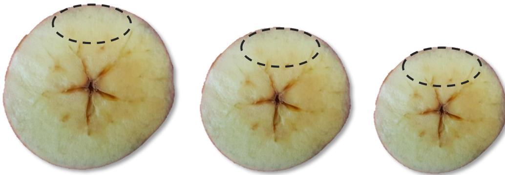
Figur 52. Kor langt inn i eplet NIR-strålinga vil gå er avhengig av storleik på eplet. Det stipla området illustrerer området NIR-spektrometeret måler. Dette området er konstant, men storleiken på epla er variabel, noko som fører til at det vert målt ulik relativ lengd inn i epla.. Foto: Ingvill Hauso
