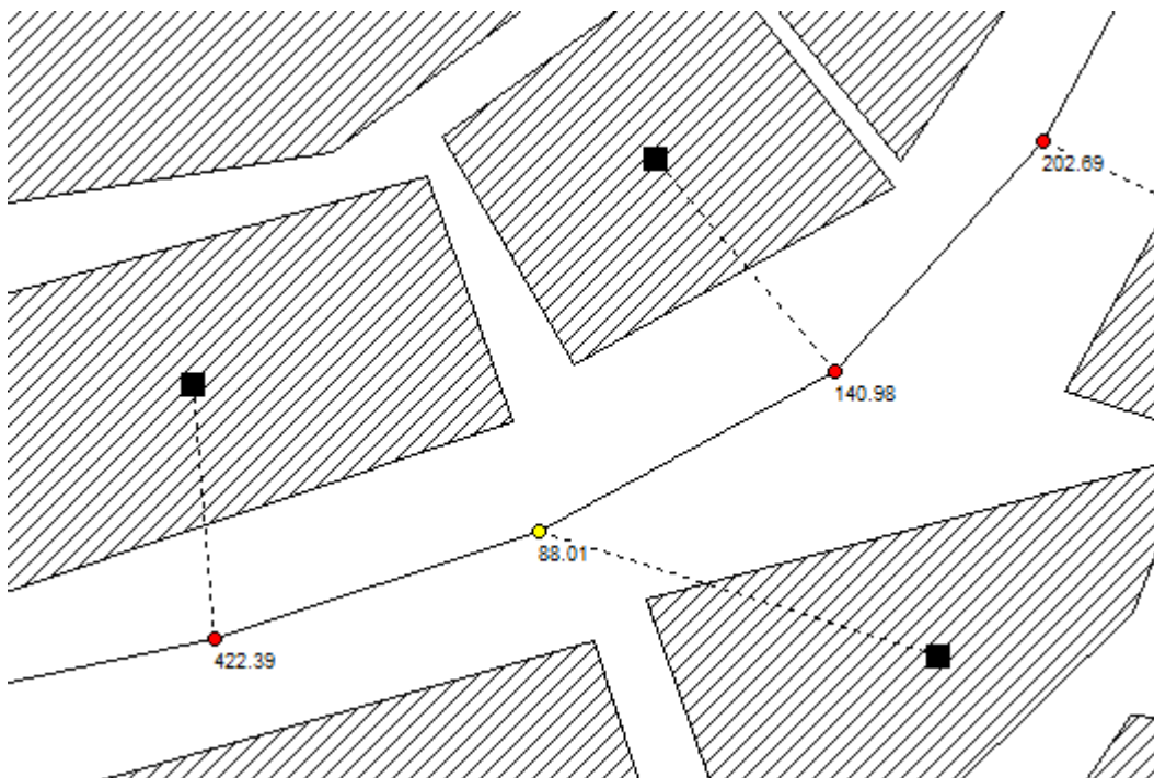
Figur 4-3 Utklipp fra modellen. Området tilsvarende den midtre delen av Evenrødbekken. Tallene tilsvarende mengden vann som forsvinner ut av modellen i l/s ved tiden 2t 40 min etter simuleringsstart.
