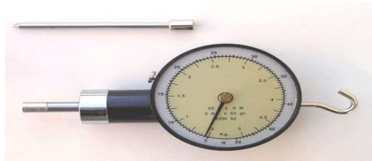
Figur 3.3. Penetrometer for å måle fastheten i eplene. Foto: Facchini sri.
