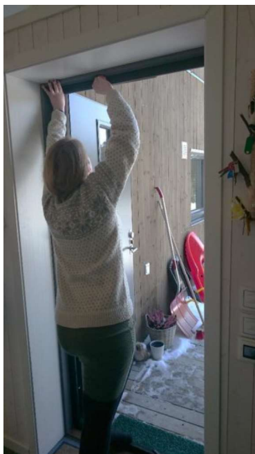
Figur 3-7: Montering av BlowerDoor-stativ i ytterdør. Foto: Malin Jonasson
