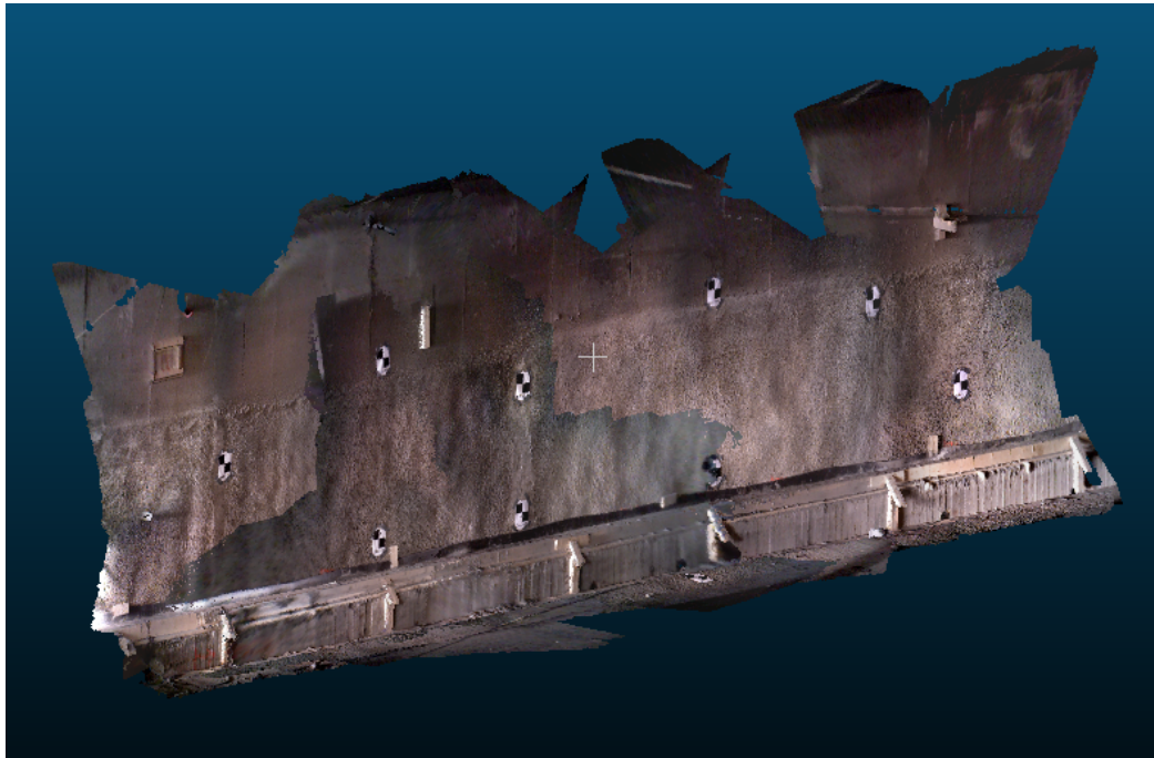
Figur 6.4: Punktsky fra andre skanning med DPI-8 som ikke er optimalisert
