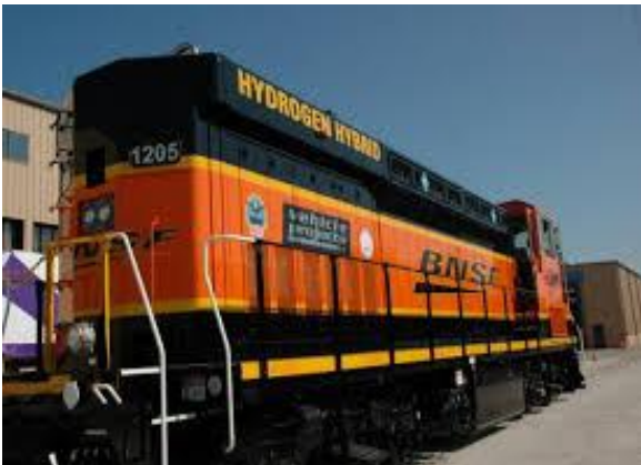
Figur 10: BNSFs hybridlokomotiv med brenselceller og batteridrift (Hess et al., 2010).
