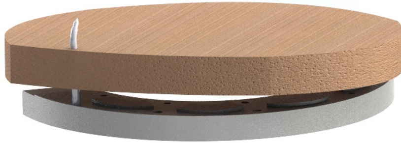
Figur 60: Når kloen har kommet opp gjennom vevet, vil den oppta en bueform som fører den tilbake gjennom vevet og til festehullet.
