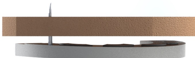
Figur 59: Umiddelbart i det aktiveringsstaven blir trukket ut, vil hver enkel klo penetrere vevet. Her blir den første kloa frigjort og har kommet gjennom vevet.
