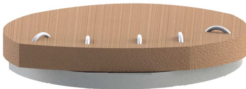
Figur 62: Samtlige klør vil gjennomgå en tilsvarende prosess, når de har inntatt riktig posisjon og frigjort ved hjelp av aktiveringsstaven. Her er alle klørne fra forankringselement 1 blitt fiksert på mitralklaffen.
