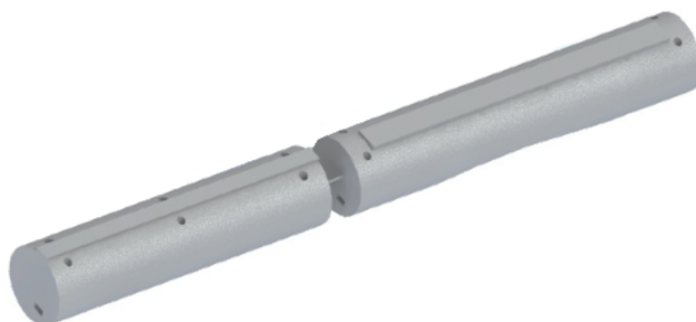
Figur 13: Presentasjon av det endelige konseptet. Devicen har to identiske stenger med magnetisk plate og integrerte klør. Klørne er på innsiden av devicen når den føres frem med kateter.
