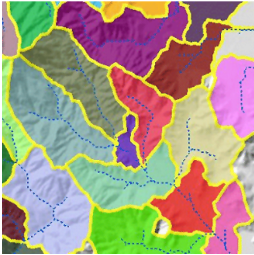
Figur 23: Eksempel på definering av nedbørsfelt med verktøyet "Watershed". (ESRI, How Watershed works, 2012)
