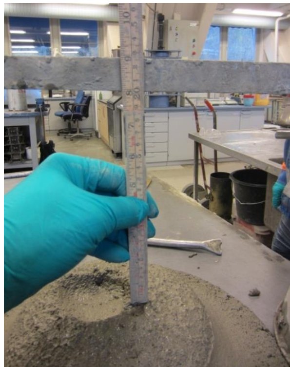
Figur 3-6 Kontrollrutine for måling av synk. Foto: Gunleiv Sæland
