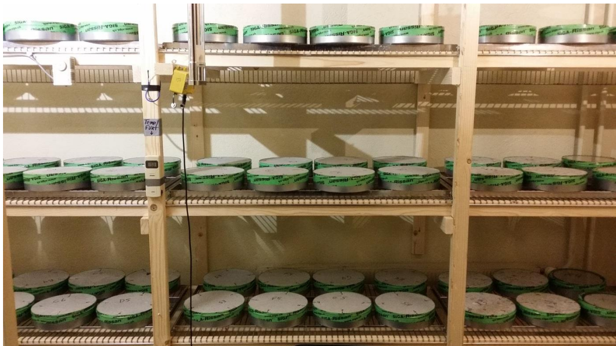
Figur 3-20 Prøvene blei plassert i hylle med tre høgder i klimarommet. På bildet visast også styre- og loggeutstyr for temperatur og fuktnivå i rommet. Foto: Gunleiv Sæland
