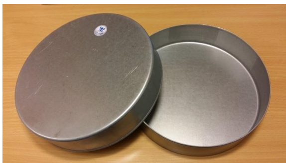
Figur 3-5 Ventilasjonsendelokk med same diameter som støypeformene. Foto: Gunleiv Sæland
