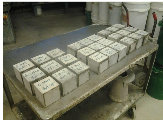
Figur 3-12 Mørtelprøver til kontroll av fastleik. Biletet viser terningprøver tilhørande sylindertestene på biletet til venstre. Foto Gunleiv Sæland
