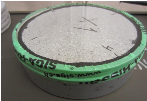
Figur 3-18 Dummy-prøve med tett glasslokk. Foto: Gunleiv Sæland
