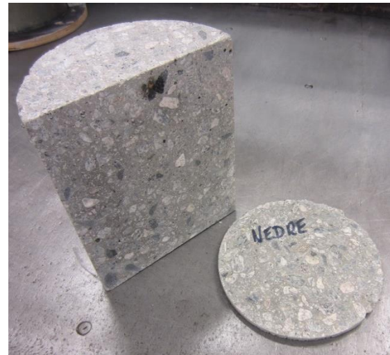
Figur 3-10 Kontroll av separasjon i vibrert betongprøve. Tilslaget er framleis jamt fordelt øvst og nedst. Foto: Gunleiv Sæland
