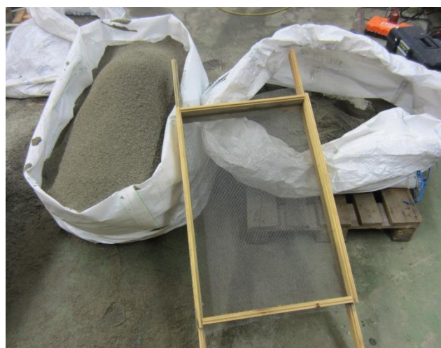
Figur 3-3 Sikting av sand. Fraksjonen 0/8 mm (til høgre) blei sikta ned til 0/3 mm (til venstre) til bruk i mørtelprøvene. Foto: Gunleiv Sæland
