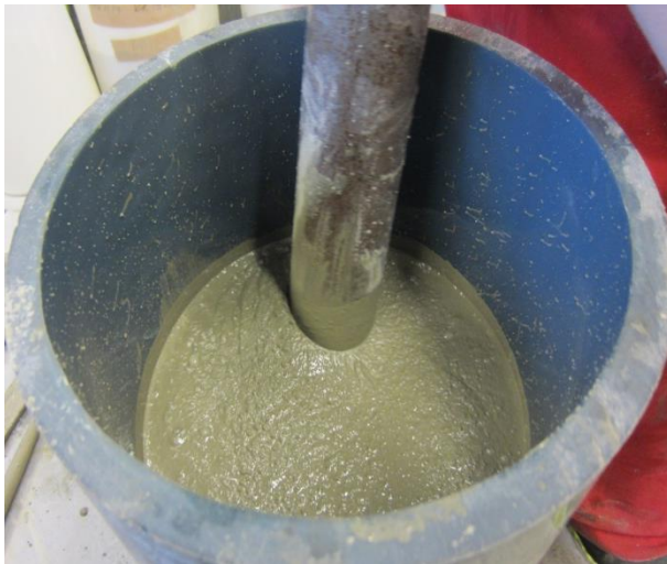
Figur 3-9 Vibrering av mørtelprøve i fleire lag. Foto: Gunleiv Sæland
