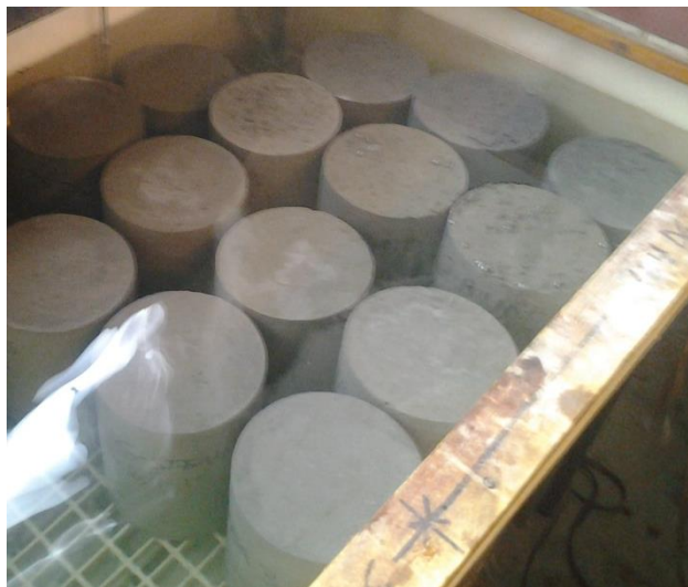
Figur 3-13 Herding i neddykka tilstand i herdebasseng hos Norcem FoU. Foto: Gunleiv Sæland
