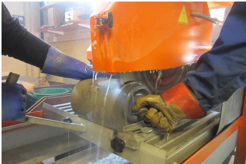
Figur 3-14 Saging av prøvestykke. Sugekopp blei brukt for å halde skiva fast etter gjennomskjering. Av praktiske årsakar og tryggleikssyn var det alltid to personar til stades under saginga. Foto: Hans Jørgen Bjerva
