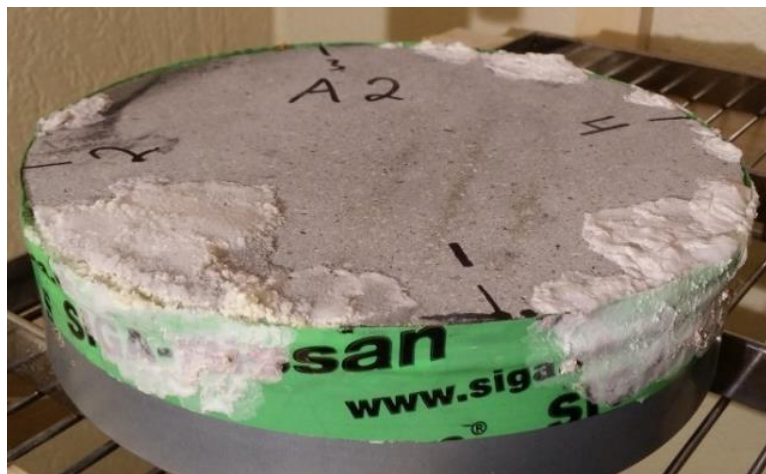
Figur 3-22 Prøve med tydeleg saltgjennomtrenging. Biletet er teke to månader etter avslutta forsøk. Foto: Gunleiv Sæland
