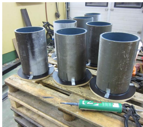
Figur 3-4 Støypeformer laga av 200 mm trykkrør i polyetylen. Tetting med Tec7 og skrueforbinding mot finerplate i botn. Foto: Gunleiv Sæland
