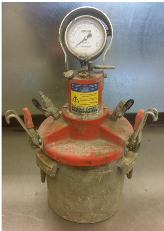
Figur 3-7 Luftmålar av typen FormTest B2020. Foto: Tor M. Zachariassen, Norcem
