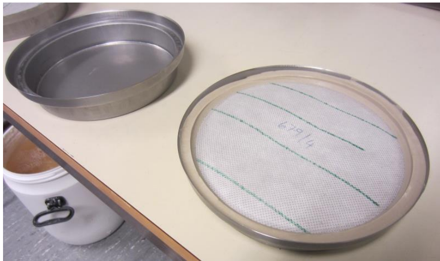
Figur 3-2 Døme på montering av prøve i laboratoriet til Sintef i Trondheim. Her ved testing av vindsperreprodukt. Foto: Gunleiv Sæland
