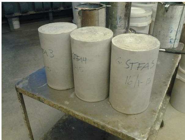
Figur 3-11 Avforma mørtelprøver klare til herding i vatn. Desse brukast i dei seinare diffusjonsforsøka. Foto Gunleiv Sæland
