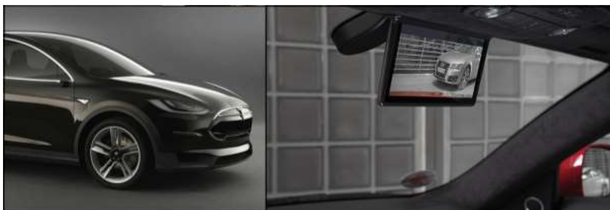
Figur 56 Bildet til venstre viser Tesla Modell X uten sidespeil, mens bilde til høyre viser Audi R8 e-tron med digitalt bakspeil [54][55]
