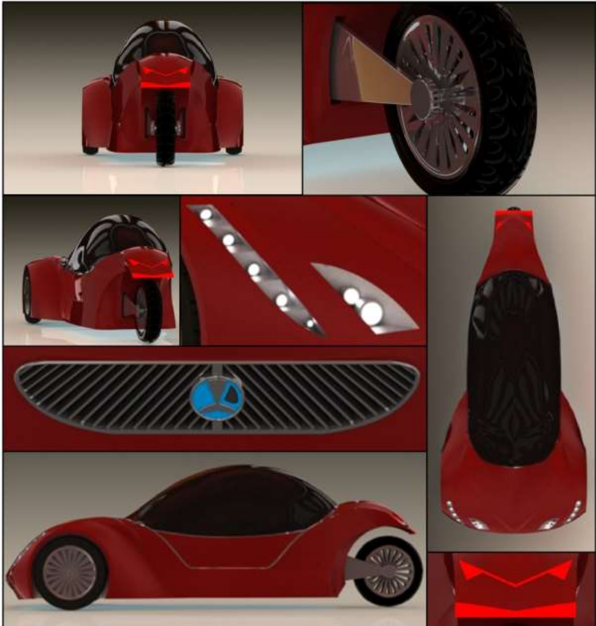
Figur 95 Illustrasjon av Dolphin Expression 2.0 sett fra forskjellige vinkler og zoomet inn på forskjellige detaljer. Viser kjøretøyet sett fra bakfra, ovenfra, sett fra siden, samt detaljer som felger, frontlykter, grill og baklykter
