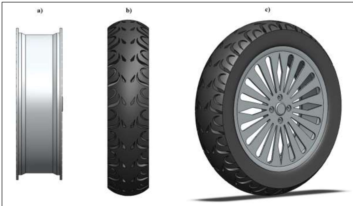
Figur 72 Illustrasjon som viser hvordan felg og dekk er utformet, hvor a) viser felgen sett fra siden, b) viser dekket sett fra siden med dekkmønster og c) viser hvordan hjulet ser ut når felg og dekk er satt sammen
