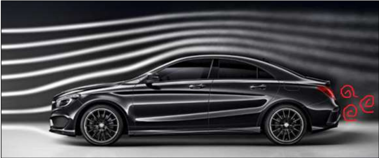
Figur 25 Mercedes-Benz CLA illustrert i en vindtunnel, C_d = 0,22 . Virvlene merket med rødt skal illustrere lavtrykksområdet som oppstår bak bilen. [28]
