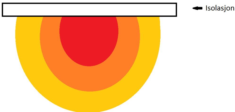
Figur 13. Illustrasjon av en temperert brønnpark som er isolert i overkant, sett fra siden. Rød farge viser til den varmeste delen, oransje viser til den mellomtempererte delen og gult viser til den kaldeste delen av brønnparken.
