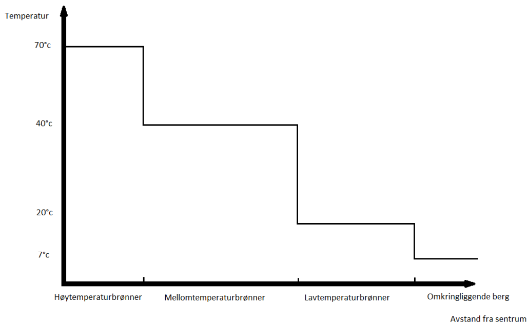
Figur 20. Ideelt temperaturprofil for brønnparken dersom det ikke er varmeutveksling mellom de ulike delene av brønnparken.
