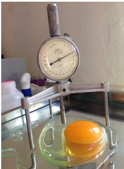
Figur 16: Instrumentet som ble brukt til måling av hvitens høyde var et mikrometer. Egget knekkes over glassplaten og mikrometeret settes så over slik at målepinnen vil treffe ca. midt på hvitens viskøse del. Målepinnen skrues ned og høyden på hviten leses av i millimeter. Foto: Camilla Mikalsen
