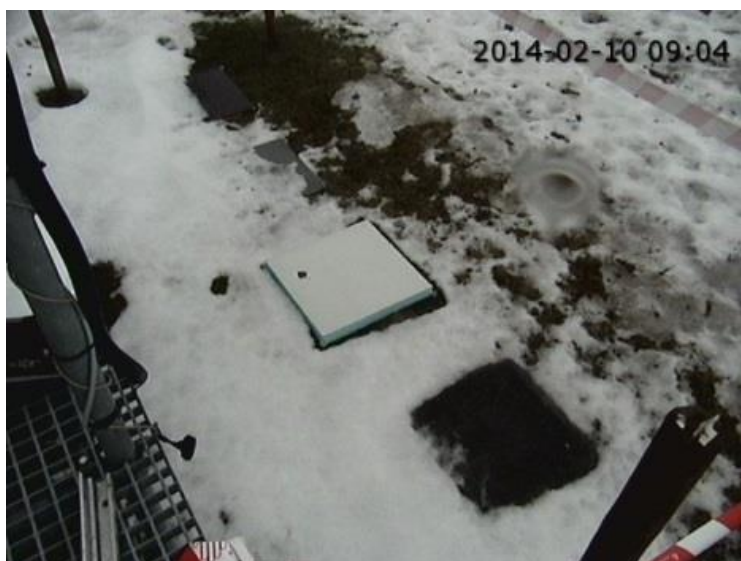
Figur 4.1: Ujevn snøsmelting på Blindern 10. februar 2014 kl. 09:04. Litex-Membranplaten og sanden er fri for snø, mens kryssfiner- og GRP-platen er delvis dekket selv om gresset foran platene er bart.
