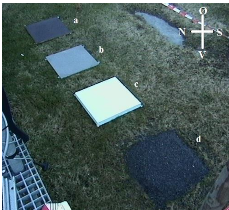
Figur 3.11: Oppsettet av underlagsforsøket på Blindern vinteren 2013-2014. I venstre hjørne kan deler av en målerigg ses. Underlagene som ble testet var a) kryssfinerplate, b) GRP-plate, c) Litex-Membranplate og d) sand.
