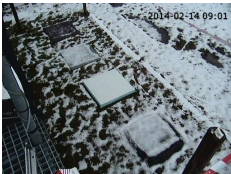
Figur 4.2: Snødekke på Blindern 14. februar 2014 kl. 09:01. GRP-platen nest øverst smelter mest likt gresset omkring, mens kryssfinerplaten og Litex-Membranplaten allerede er bsnøfrie.
