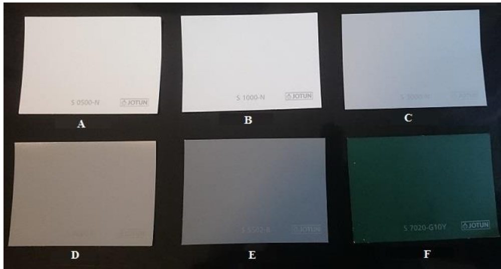
Figur 3.19: De ulike fargene som ble testet med signalstyrken til SHM 30. Fargene er kodet fra A til F hvor A er den lyseste hvite og E er mørk grå. F er den grønne fargeprøven.
