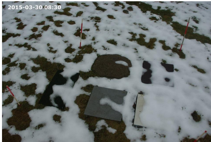
Figur 4.6: Variasjon i snødekke på de ulike underlagene ved smelting. Sand og GRP-platen er nesten helt bare, mens Litex-Membranplaten er nesten helt dekket. Ved å sammenligne med omkringliggende gress er overflaten på kryssfinerplaten og kunstgresset mest likt naturlig gress.
