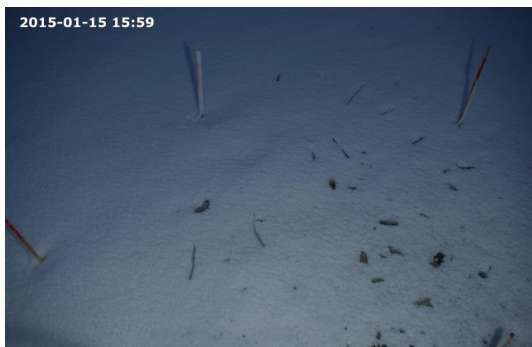
Figur 4.3: Eksempel på snøkast fra målemasten. Snøen smelter først rundt hullene som er dannet i snødekke og gjør at forskjellene i smelting på de ulike underlagene ikke kan benyttes til å påvise forskjeller mellom underlagene.
