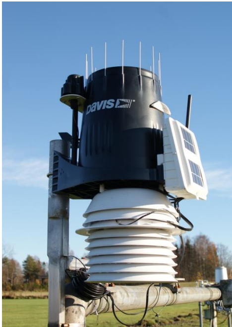
Figur 3.4: Davis stasjonen montert på Søråsfeltet. Stasjonen er av typen Vantage Pro2.
