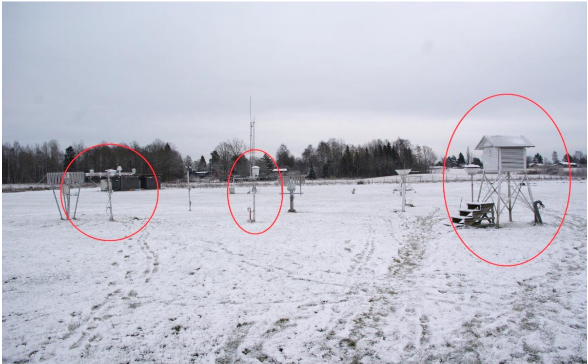
Figur 3.7: Oppsettet av skjermene på Søråsfeltet. De røde ringene markerer de forskjellige skjermene. Ringen til høyre viser stativet med de fire skjermene. Ringen i midten viser multiplateskjermen fra MET og ringen til høyre viser trehytten fra MET.
