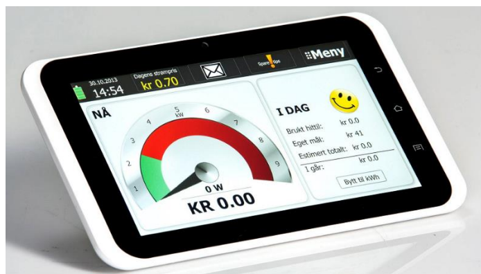
Figur 3-8 Styringscenter brukt på Hvaler. Forbruker har et eget apparat, liknende nettbrett, som gir et interaktivt og oversiktlig bilde av eget forbruk. Figuren er kun et eksempel. Kilde: tu.no
