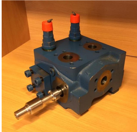
Figur 6-1: Viser volumstrømdeleren til Mannesmann Rexroth i støpestål, der alle hull er boret. Foto: Simen Hemstad
