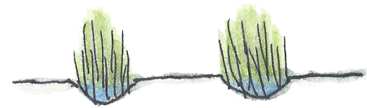
Fig. 4.6. Kombinasjon av energiskog og lokal overvannsdiskonering, for eksempel i forbindelse med parkeringsplasser.
