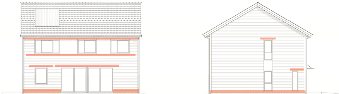
Figur 3.5.1.1. Fasadene på en enebolig fra Nordbohus – røde linjer indikerer utsatte områder
