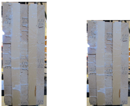
Figur 9 Venstre: tverrsnitt L-3 (300x100mm 2 ). Høgre: tverrsnitt L-2 (200x100mm 2 ).
