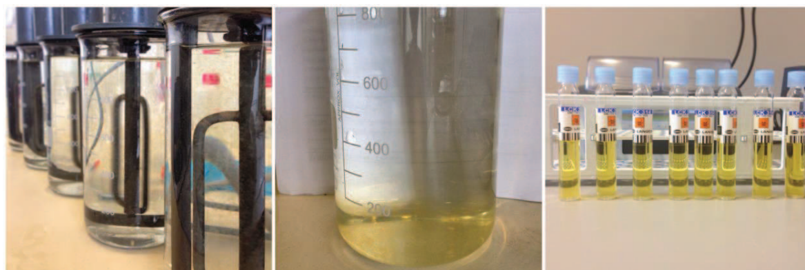
Figur 12: Flokkulering, sedimentering og HACH Lang LCK314
