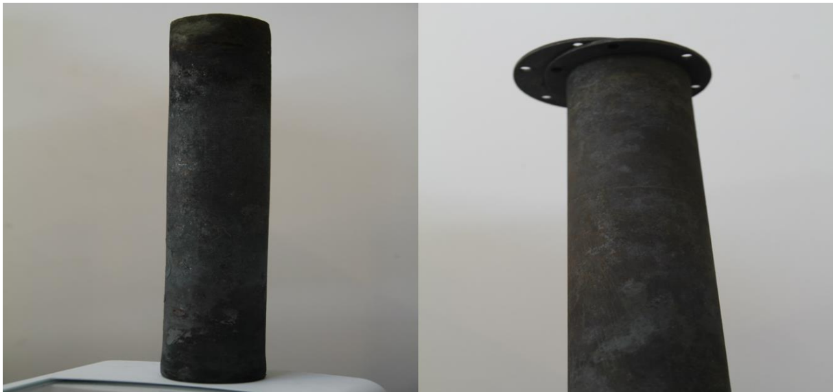
Figur 37: Bildet viser nikkelsmeltedigelen (venstre) og ytre stålhylse (høyre) som ble benyttet under forsøkene.
