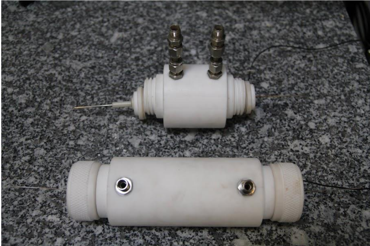
Figur 18: Bildet viser de to elektrostatiske filterene som ble testet og deretter brukt i forsøkene. Nederst på bildet kan man se det nye filteret som erstattet det gamle.
