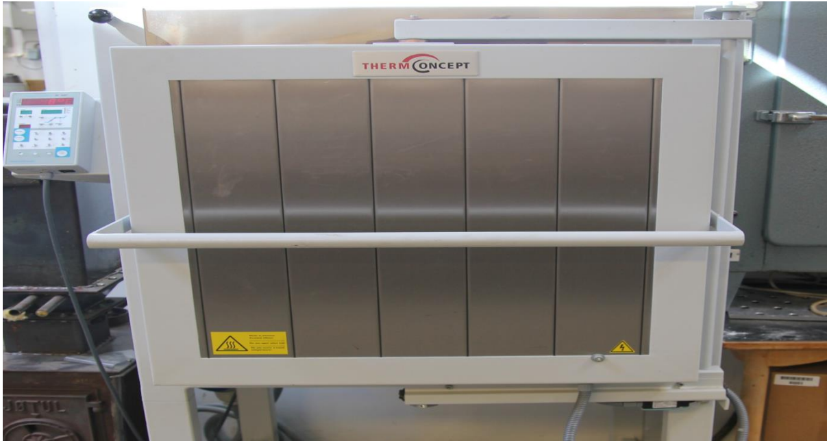
Figur 39: Bildet viser ovnen som ble benyttet for nedsmelting og gløding av kjemikalier.
