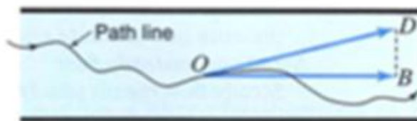
Figur 4: Turbulent strømning. Strømningsmønster for en partikkel
