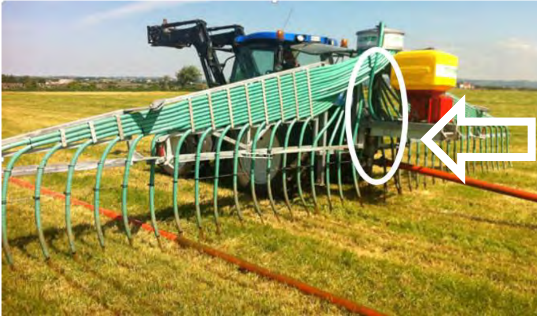
Figur 27: Stripesprederen med mulighet for våtsåing. Systemet som undersøkes i oppgaven er markert med hvit ring.
