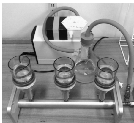
Fig. 3.4. Utstyrsoppsett for måling av tablettenes vannløselighet.
