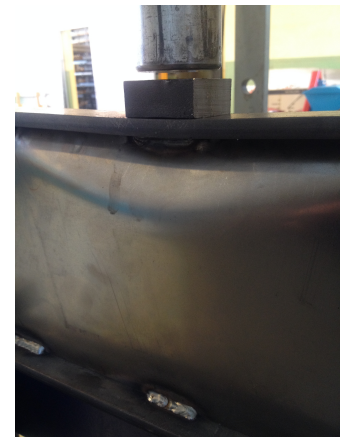
Figur 5.3 Overgang stempel, belastningskloss og platebærer
