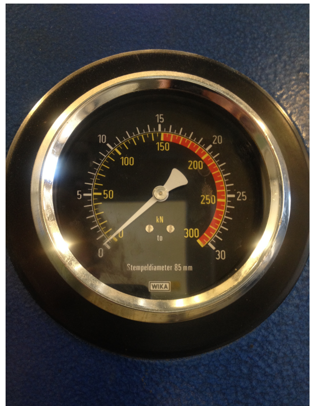
Figur 5.2 Integrert måleinstrument i pressa
