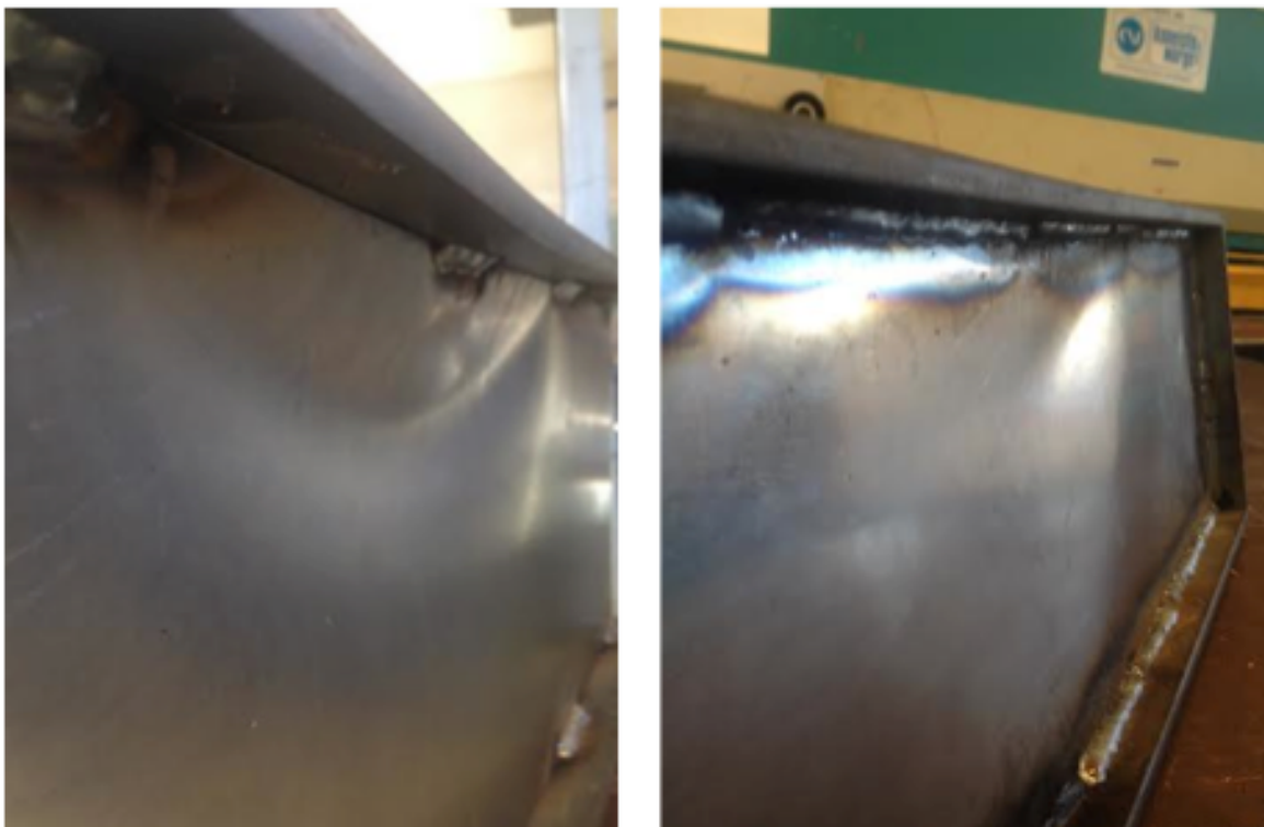
Figur A.2.1 Venstre bilde viser intervallsveis og høyre bilde kontinuerlig sveis
