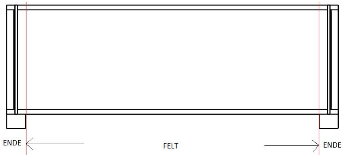
Figur 4.2 Ende og felt definert for platebærer
