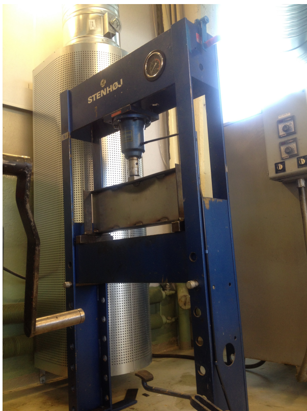
Figur 5.1 Hydraulisk presse av type Stenhøj
