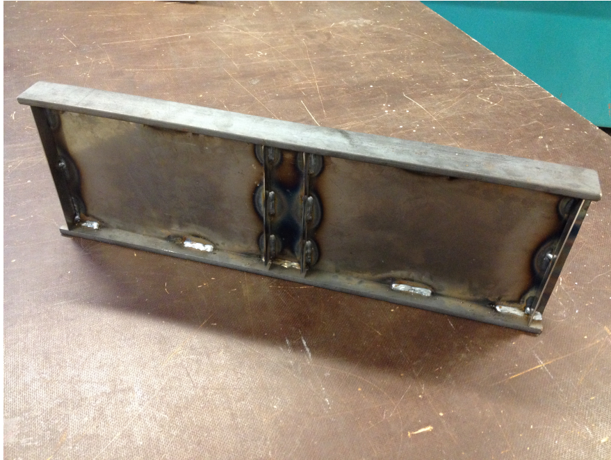
Figur 5.9 Platebærer med endestiverpar og to stiverpar a = 50 mm sentrert om punktlasten
