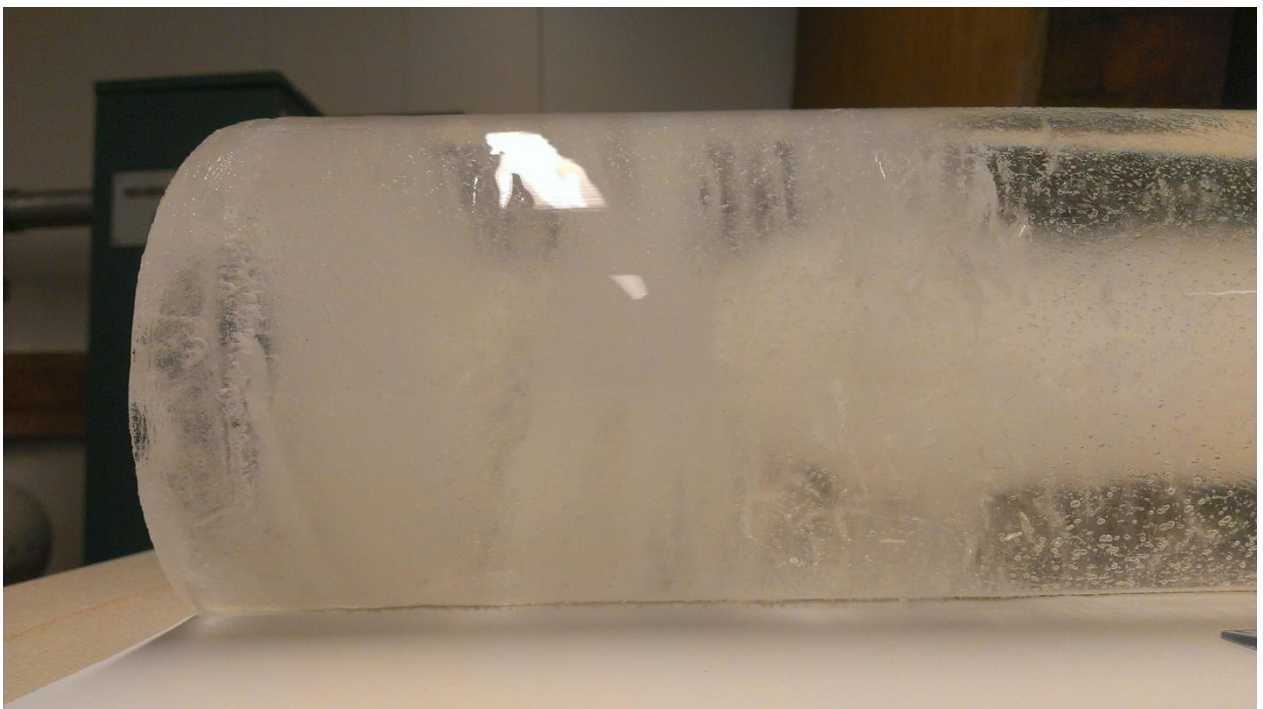
Bilde 7.8 Øvre del av isen fra DN100-røret, gjennomfrosset.
