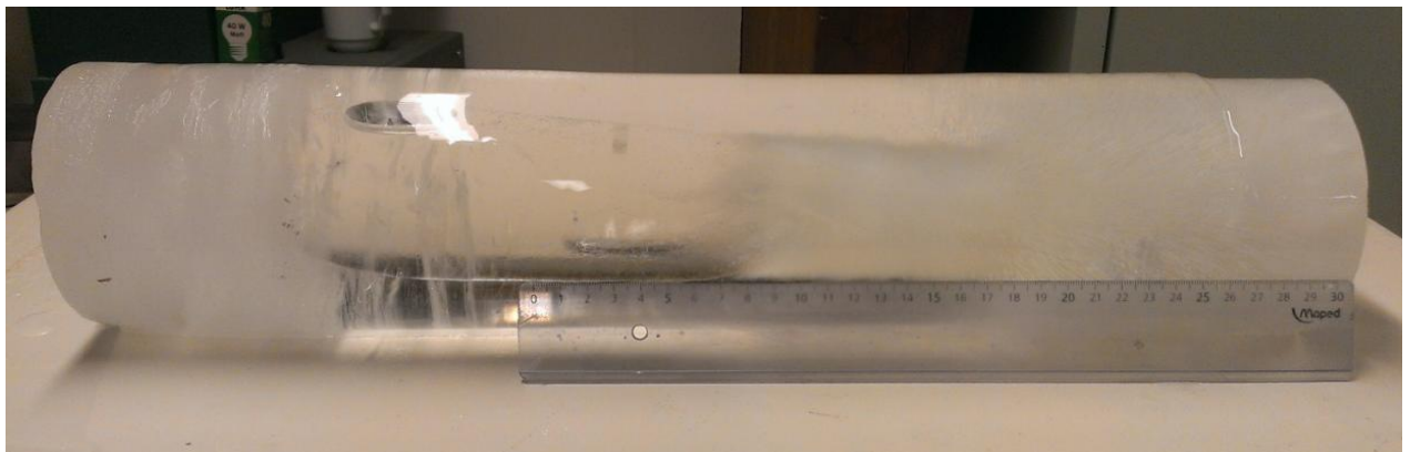
Bilde 7.6 innelukket vannlomme i DN100-røret
