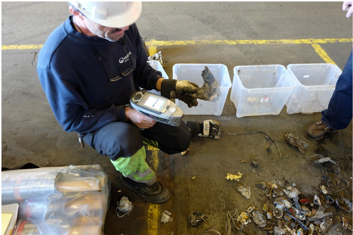
Figur 16 Benytter Thermo Scientific Niton XL3t for å bestemme metaller fra prøver. Foto: Knut Erik Haugen
