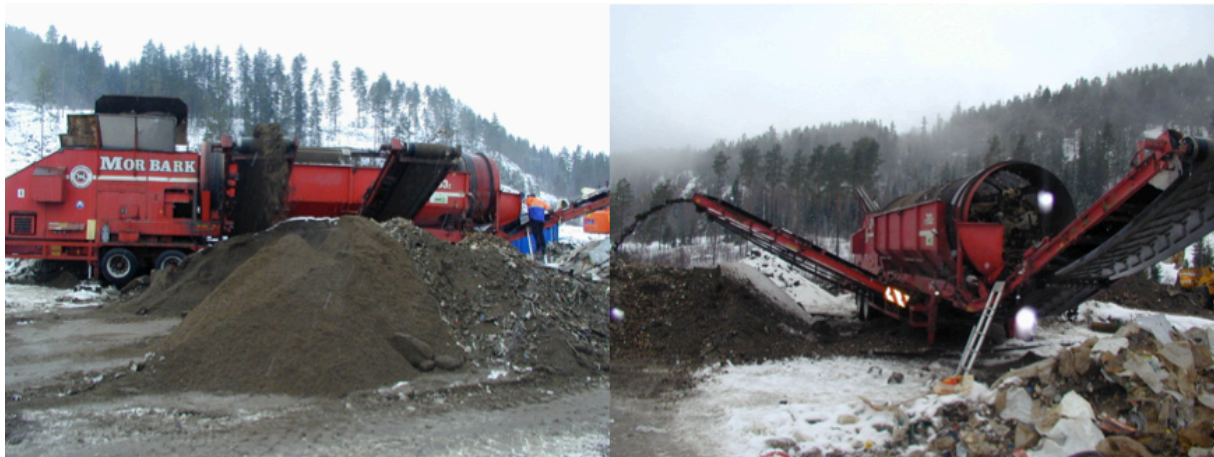
Figur 22 Trommel som ble benyttet ved Korperud Avfallsanlegg
