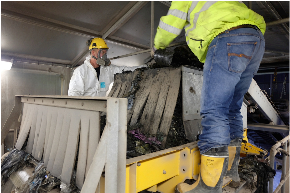
Figur 14 Opphopning av avfall ved luftseparator. Foto: Knut Erik Haugen
