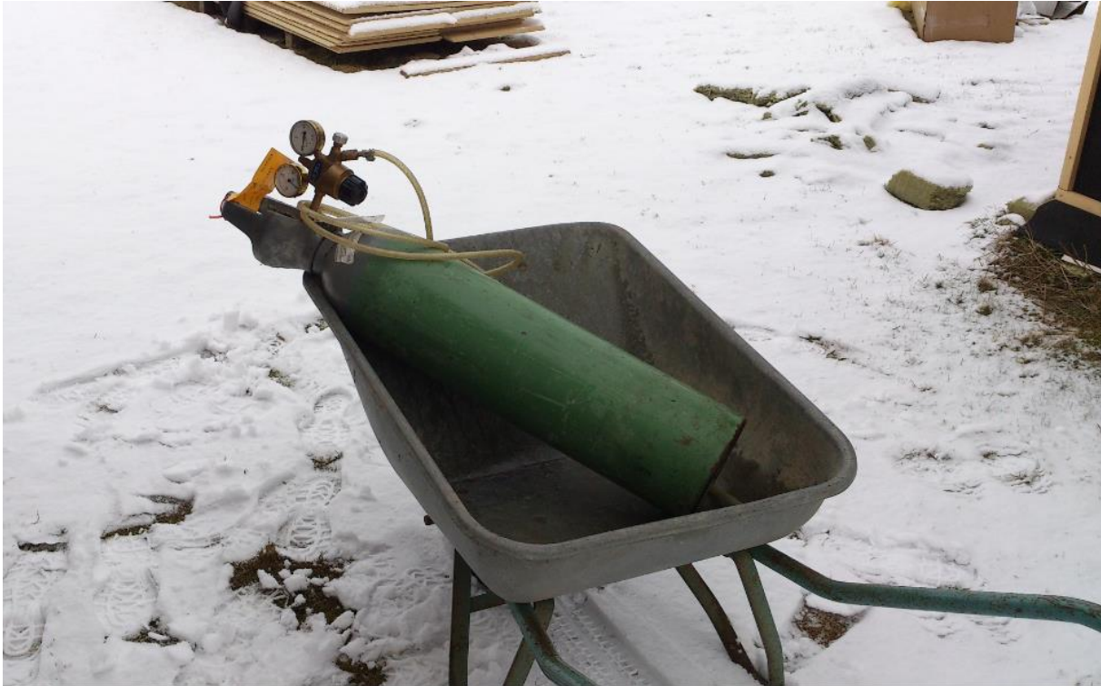
Figur 4: Bildet viser hvordan CO 2 -tanken ser ut. Dette bildet ble tatt da tanken gikk tom og slangedelen måtte byttes over til en ny tank.
