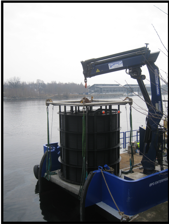
FIGUR 5.10: BILDE AV TROMMELKOLLEKTOR MODELL CWX-10 FØR DEN SENKES NED I SJØEN.
