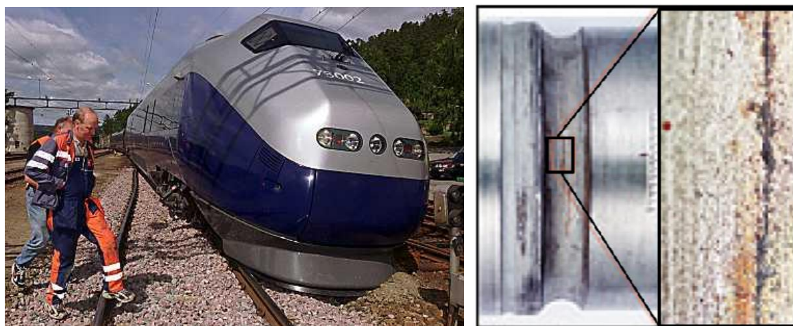
Figur 7: Det avsporede toget ved Nelaug stasjon, og akslingen som røk [10].
