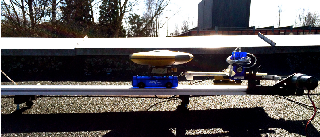
Figur 4.6: Bane med motor som driv ei vogn. GNSS-mottakar vart sett oppå vogna og ein kunne stille utslaget til vogna og spenninga motoren skulle ha.
