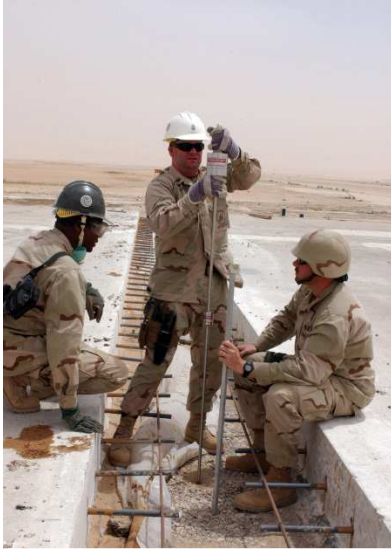
Figur 2.3: A) Måling av jordstyrke med cone penetrometer (Navy, 2014). B) Illustrasjon av cone penetrometer (Soil, 2014)
