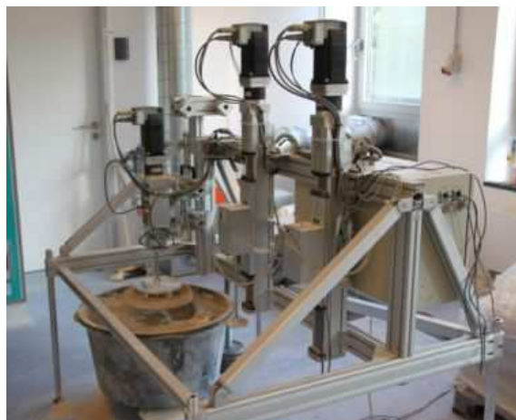
Figur 2.4: Bevameter for måling av jordstyrke (Bevameter, 2014)
