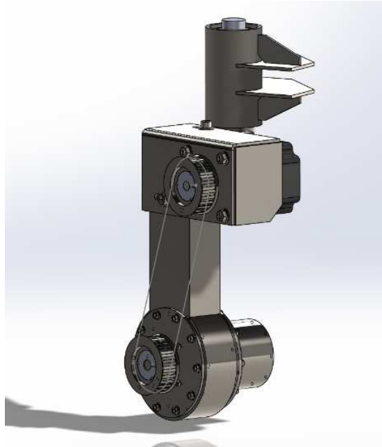
Figur 3.4: SolidWorks modell som viser motor, girkasse, og tannreimsdrift. (Laget av Fredrik Blomberg)
