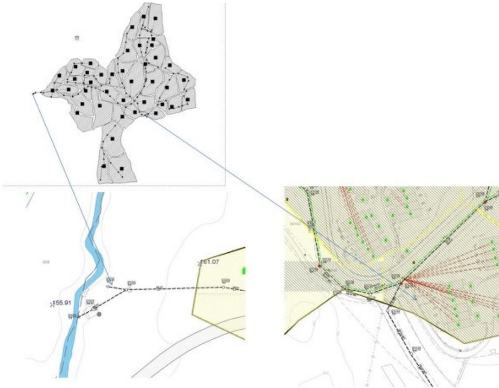
Figur 5.5: a) Øverste bildet viser SWMM modellen. b) Bildet nederst til venstre viser kritisk punkt 1. c) Bildet nederst til høyre viser kritisk punkt 2 (Gemini VA 2014).
