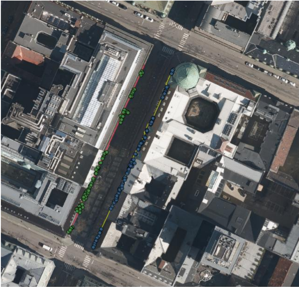
Figur: 4.10: “Fasadeliv 1 fot” og “Fasadeliv 2 fot” fra TerraScan plottet mot fasitlinjene.
