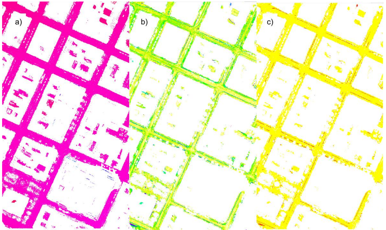
Figur 3.10: a) Bakkemodellen lastet inn som raster. b) Raster med "slope"-egenskapene til bakkemodellen. c) Områdene med en vinkel på 10 til 20 grader, vist i rødt, er valgt ut. Områder utenfor dette får fargen gul.
